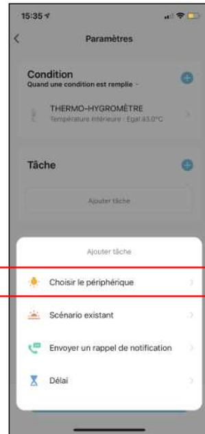
Pour programmer le capteur connecté en fonction d'un scénario déjà enregistré, appuyer sur «Scénario existant».
