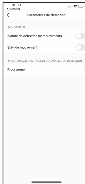
Cet appareil est capable de détecter les mouvements dans son champ de vision. En cas de détection de mouvements, une vidéo est enregistrée et vous recevez une notification.
